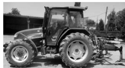
Рис. 2. Культиватор-рыхлитель виноградниковый УК-3 на операции культивация междурядий с обработкой межкустовых полос в агрегате с трактором TL-100 «NEW Holland»
