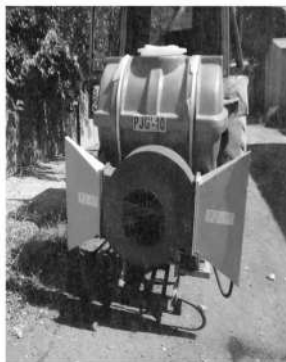
4-расм. Янги технология асосида боғларга кимёвий ишлов берадиган PJG'-10 универсал осма пуркагичнинг ишлаш жараёни.
