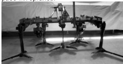
Рис.1. Культиватор-рыхлитель виноградниковый УК-3 на операции культивация междурядий с обработкой межкустовых полос
