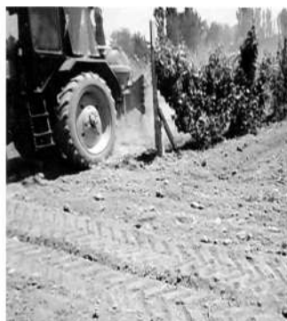
4-расм. Янги технология асосида боғларга кимёвий ишлов берадиган PJG'-10 универсал осма пуркагичнинг ишлаш жараёни.
