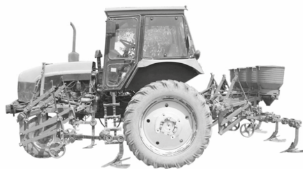
2-расм. Универсал иш органи билан жиҳозланган КХУ-4Б культиваторининг умумий кўриниши
