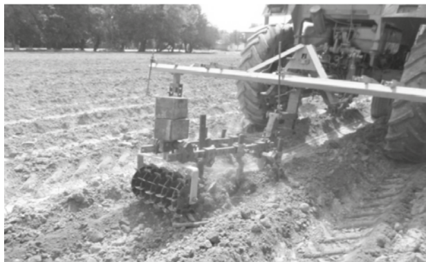
2-расм. Дала шароитида тензопасайтиргичдан фойдаланиб тензометрия ўтказиш жараёни
