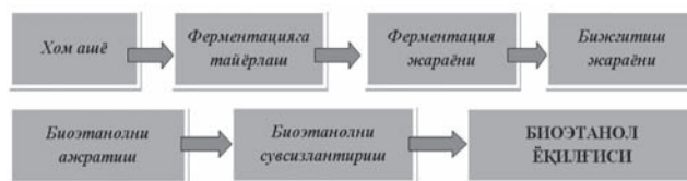
Расм. Картошкadan биоэтанол ишлаб чиқаришнинг технологик схемаси..
