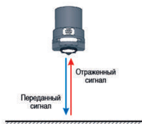
Рис.1. Микроволновой генератор датчика уровня
