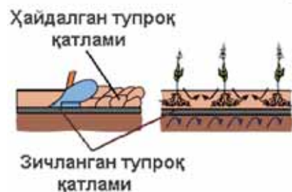
1-расм. Тупроқни бир хил чуқурликда қайта-қайта ҳайдалиши натижасида зичланган тупроқ қатламини ҳосил бўлиши
