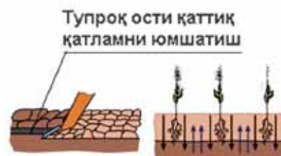
2-расм. ГРП-3/5 русумли чуқур юмшатгич билан тупроққа чуқур ишлов бериш
