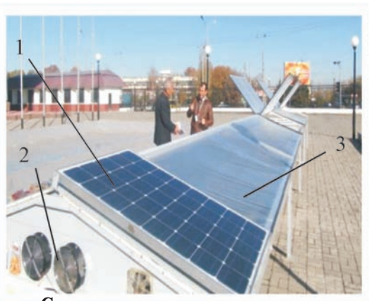
Сушильная установка под пленочным покрытием с использованием солнечной батареи 1-солнечная батарея; 2- вентилятор; 3-пленка
