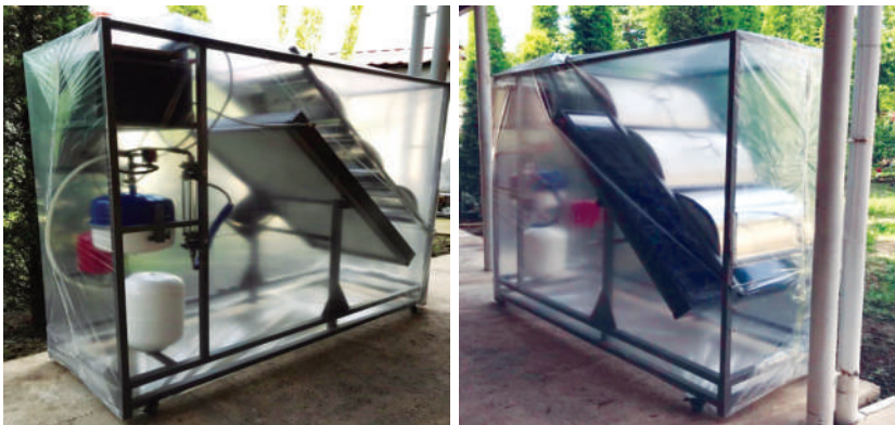
1-расм. Қуёш коллекторларини турли хил шароитларда мавсумий синаб кўриш инновацион энергия тежамкор лаборатория стендининг иссиқхона мисолида натижаларни олиш жараёни.
