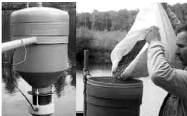
1-расм. Балиқларни автоматик озиклантириш ва етказиб бериш тизими
