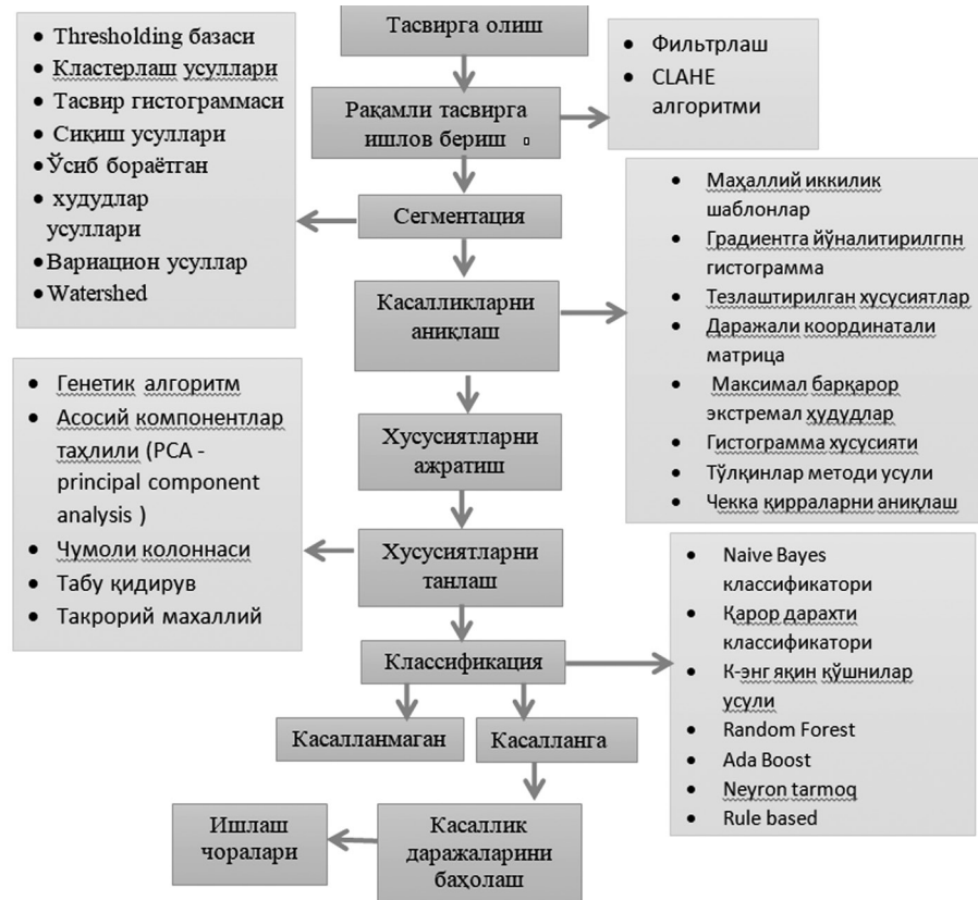
3-расм. Буғдой ўсимлиги касалликларини интеллектуал датчиклар орқали аниқлаш системасининг классификацияси [4].
