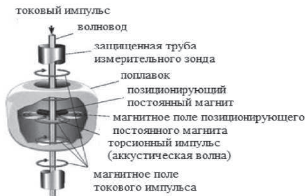
Рисунок 2. Конструкция магнитостриктивного датчика уровня.
