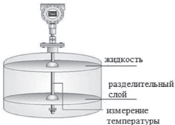
Рисунок 1. Схема установки магнитострикционного датчика уровня
